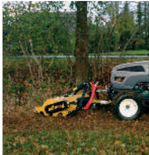
MU-C pro přední zapojení: Nízko umístěné spojovací body pro nízko uloženou převodovku (vstupní otáčky 1 000 nebo 2 000 1/min).
