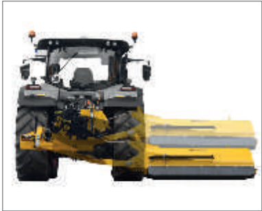
Výšku mulčovače je možné hydraulicky nastavit. Je tak možné mulčovat i plochy vedle traktoru.
