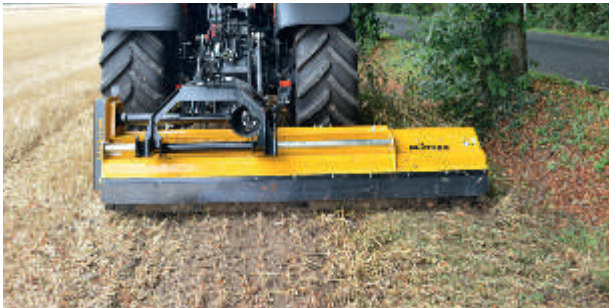
Hydraulický stranový posuv: přesazené mulčování vedle traktoru umožňuje flexibilitu při práci v okolí stromů, vjezdů nebo jiných překážek (volitelně).
