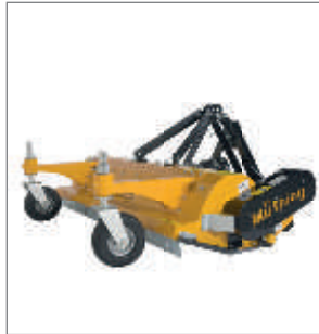
MU-C pro přední zapojení: Nízko umístěné spojovací body pro nízko uloženou převodovku (vstupní otáčky 1 000 nebo 2 000 1/min).
