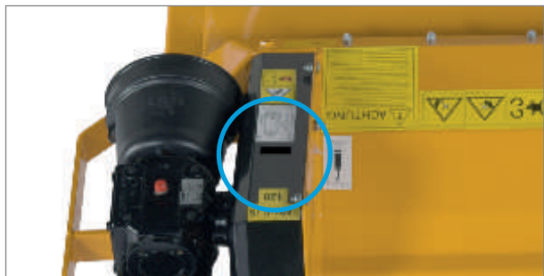
Stálý přehled o napnutí klínového řemenu: kryt klínového řemenu s kontrolním otvorem.
