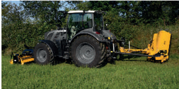
Mnoho míst pro závěs na traktor a naklápěcí kloubový hřídel.
