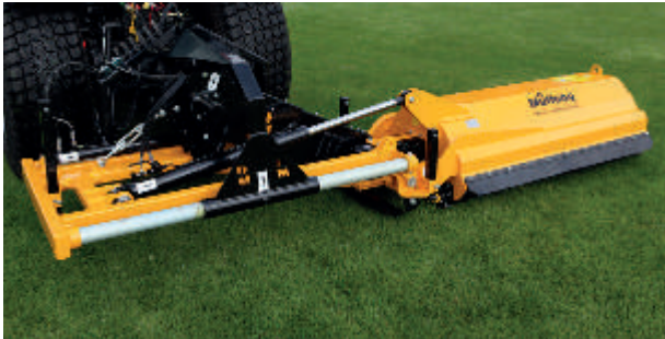
Krátký závěs pro přiblížení polohy těžiště v blízkosti traktoru.
