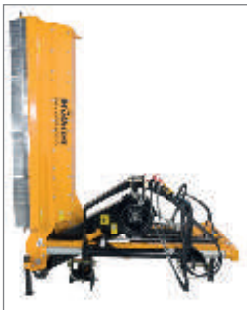
Díky promyšlené konstrukci je možné stroj MU-E/S odkládat ve složeném stavu, a ušetřit tak místo.
