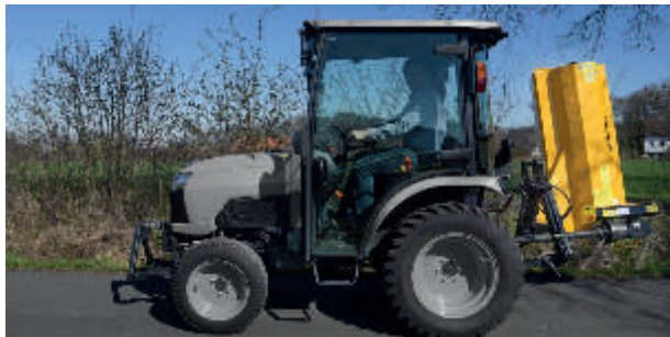
Krátký závěs pro přiblížení polohy těžiště v blízkosti traktoru.
